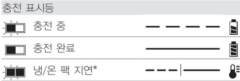
\*이 작동 상태에서는 빨간색 조명은 계속 깜박거리고 노란색 조명은 불이 켜져 있습니다. 배터리 팩이 적정 온도에 도달하면 노란색 조명이 켜지고 충전기가 충전 절차를 재개합니다.
