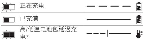
\*在此操作期间，红色灯将继续闪烁，但一个黄色指示灯将亮起。一旦电池包达到适当的温度，黄色指示灯将关闭，充电器将恢复充电程序。
